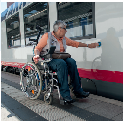
Praktisch: Türöffner und Anforderung der Rampe in Einem
